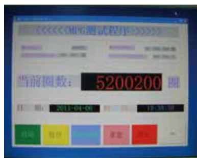
MPG壽命試驗 (連續300RPM/500萬轉以上) MPG life test (over 5 Mega Rev./300RPM)
